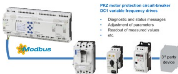
Slika 2: Povezava Modbus RTU naprav na easyE4
